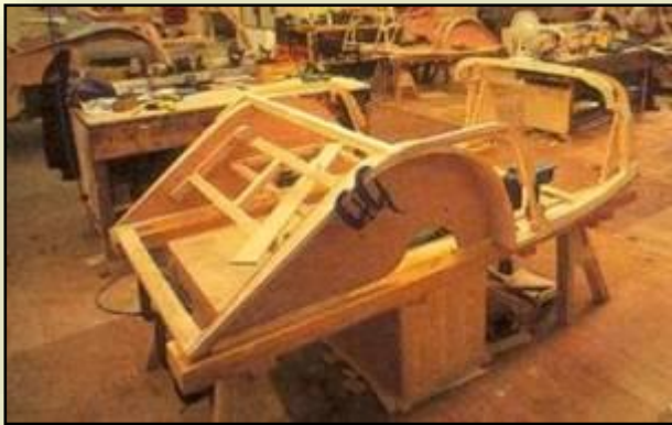
Armadura en madera de los autos a principios del siglo 20
